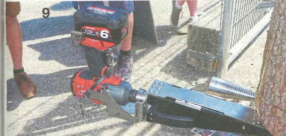
8 Forstreich bietet für seinen Fällkeil jetzt eine per Funk ferngesteuerte Ausführung an. | 9 Ebenfalls ferngesteuert ist der Fällkeil von BaSt-Ing. Hier wird der Schlagschrauber allerdings per Messband betätigt. | 10 Mit Toolprotect hat CEPAC eine Motorsägenhalterung mit Ladungssicherungsgurt entwickelt, die sich überall montieren lässt. | 11 Der weltweit ersten Niederdruck-Forstreifen F 344 ELIT von ATG kommt 2019 in den Markt und kann mit nur 2,5 bar Fülldruck gefahren werden. | 12 Der Tractor King von Nokian ist für schwierigstes Gelände in der Forstwirtschaft konzipiert.
